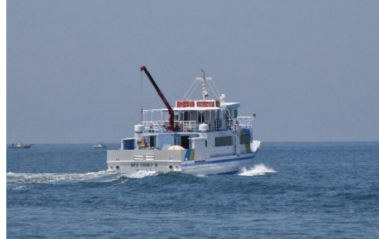
港の出口付近で出港を待ちました。伊吹島に向けて出港した NEW IBUKI II の姿です。船尾に、貨物を積載するためのクレーンが装備されています。
